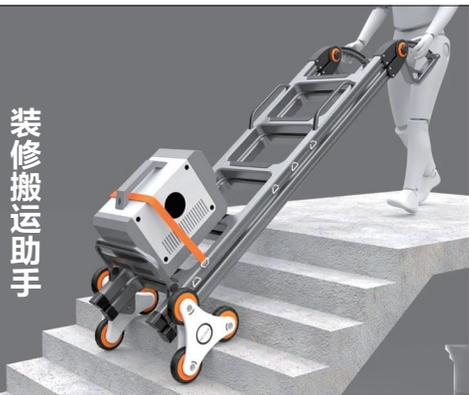
这个搬运助手的一侧设计有三角轮,可以轻松上下楼梯,轮轴上还装了锁止装备。在搬运工具或物料时,使用者只需将旋钮开关拨至转动挡位,挡板竖起,这个设备就可以被当做小推车使用。两侧还设计了挂钩,可在上面缠绕绳子用以固定所搬运的物品,防止滑落,使得上下楼搬运更安全。
